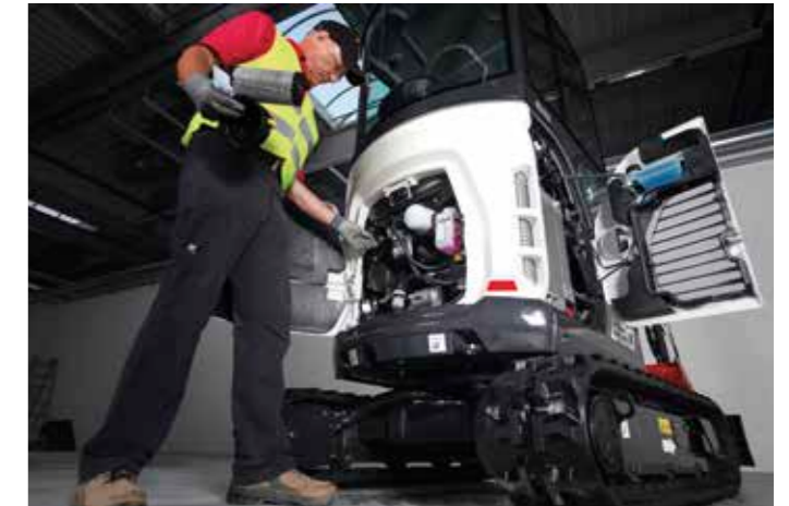
Cambio de los filtros
