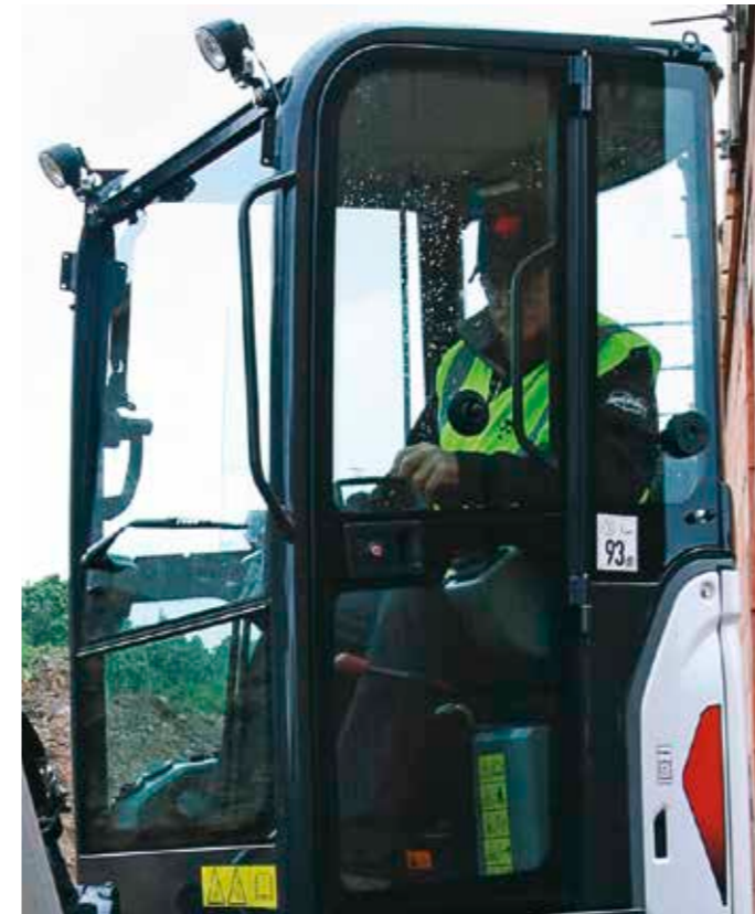
Cabina cerrada TOPS/ROPS con calefacción
