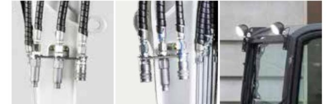
Primer conducto hidráulico AUX en el balancín
