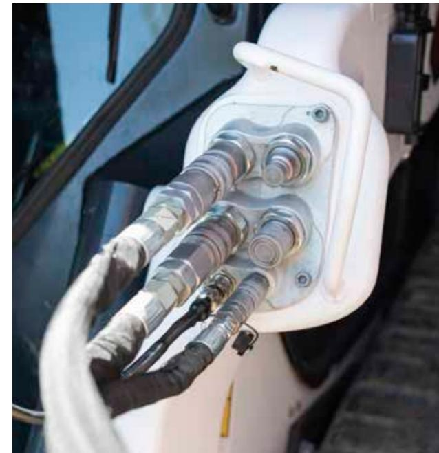
Acoplador de 5 bloques para Super Flow
